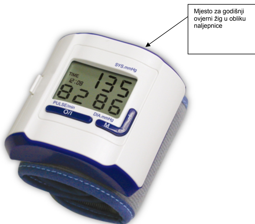
Slika 1: Elektronički tlakomjer za mjerenje krvnog tlaka tipa PBG-903
